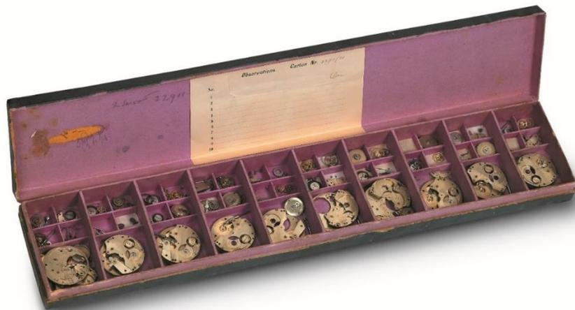
Uhrwerkteile zur Herstellung des Jones-Kalibers, um 1877. Die original erhaltene Arbeitsbox aus der Uhrwerksmontage zeigt anschaulich die einzelnen Arbeitsschritte beim Anfertigen und Montieren der einzelnen Werkteile. Wichtig ist, dass aus einer aufgelegten Serie von Uhrwerken die passgenauen Einzelstücke anhand ihrer Nummern nicht verwechselt werden können. P07 – 1259, Archiv IWC.
